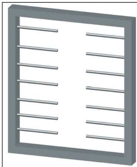
Figura 6. Estructura rectangular de PTR con varillas fijas de Cold roled 1/4". Fuente : Autores
