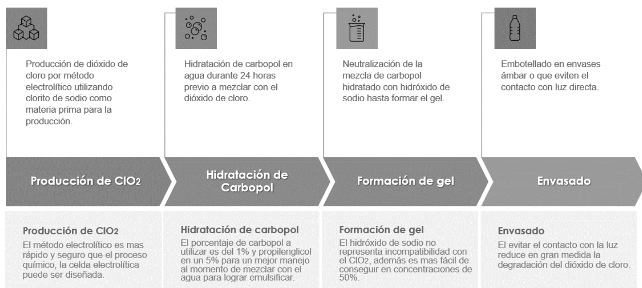
Ilustración 4. Diagrama de proceso de producción de gel de ClO 2
