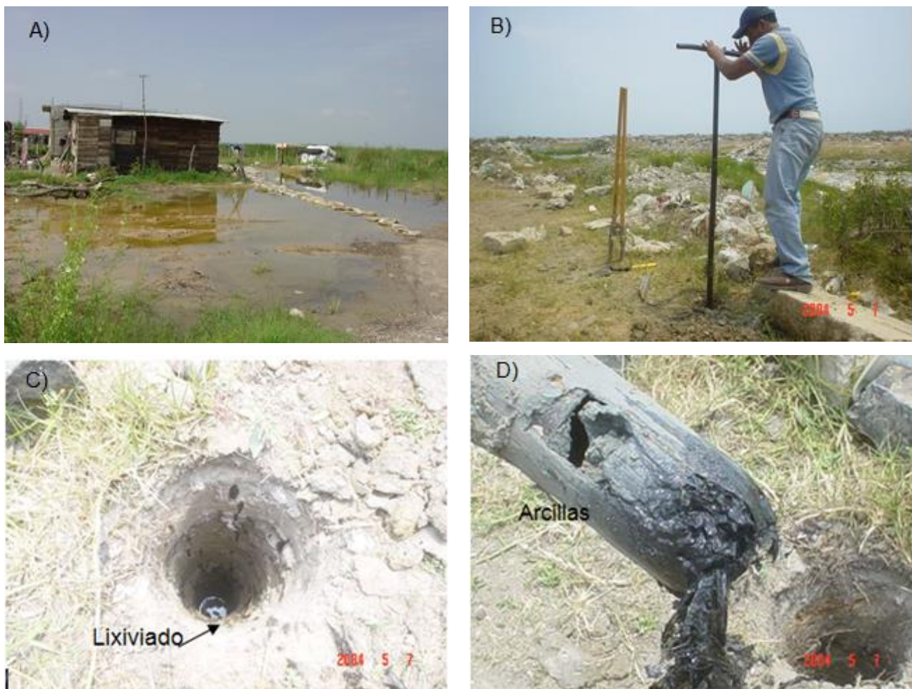
Figura 3. Área de estudio del tiradero a cielo abierto. A) acumulación de los RSU sobre cuerpos de agua, B) muestreo en la zona de interés, C) presencia de los lixiviados en los pozos perforados, D) muestra de núcleo con contaminación por lixiviados.
