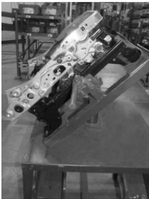
**Figura 6** Estante giratorio en la operación inspección final.
