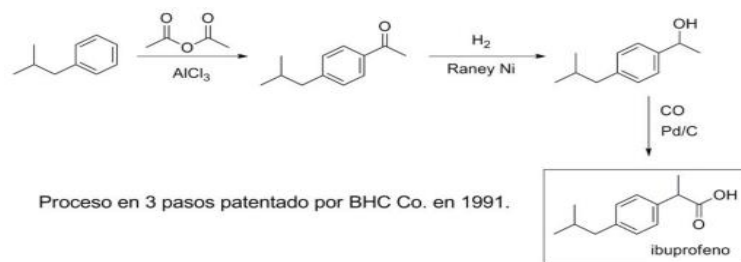
Figura 1. Dos procesos de síntesis de ibuprofeno. Fuente: Los Autores
