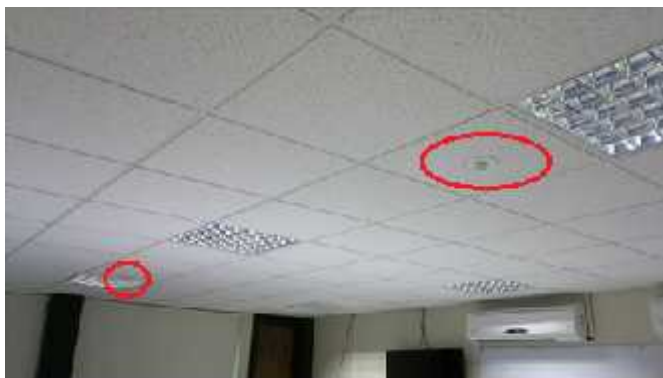
Figura 1. Posición de los sensores LX28A dentro del aula.
