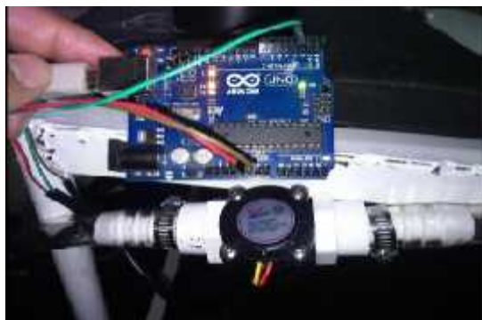
Fig. 1. Control del sensor de caudal con el ArduinoUno.
