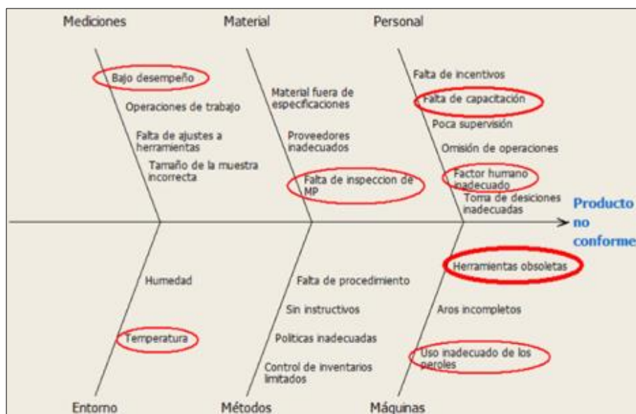
Figura 3. Diagrama de Ishikawa del producto no conforme de velas amarillas de 30 piezas. Fuente: Elaboración propia, 2017.
