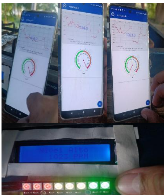
Figura 16.- Medición de Gas LP mediante la simulación de una fuga de gas LP
