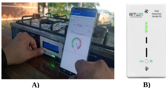
Figura 14.-Equipo puesto en prueba para medición de Gas LP, A). Medición en Smartphone, B). Detector gas comercial.
