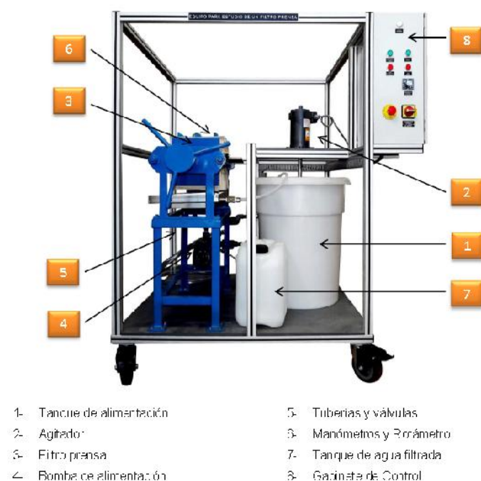
Figura 1. Equipo de filtración.
