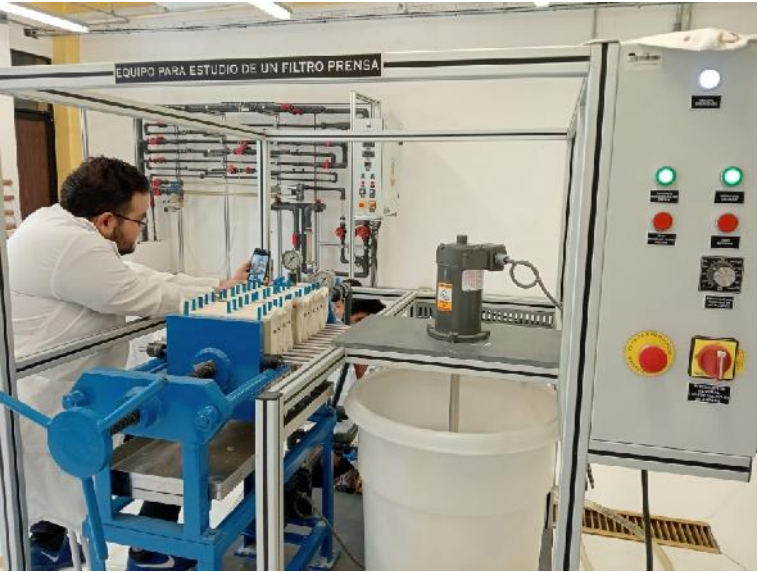
Figura 2. Equipo para estudio de un filtro prensa energizado. Fuente: Imagen tomada por el autor (2024).
