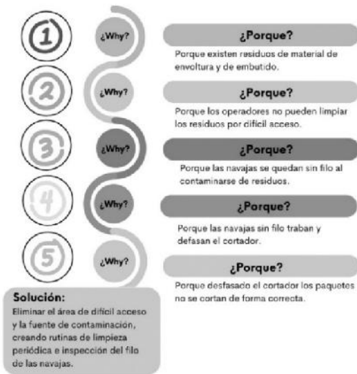
Figura 4: Herramienta “5 Whys” para la falla del cortador de la máquina empacadora
