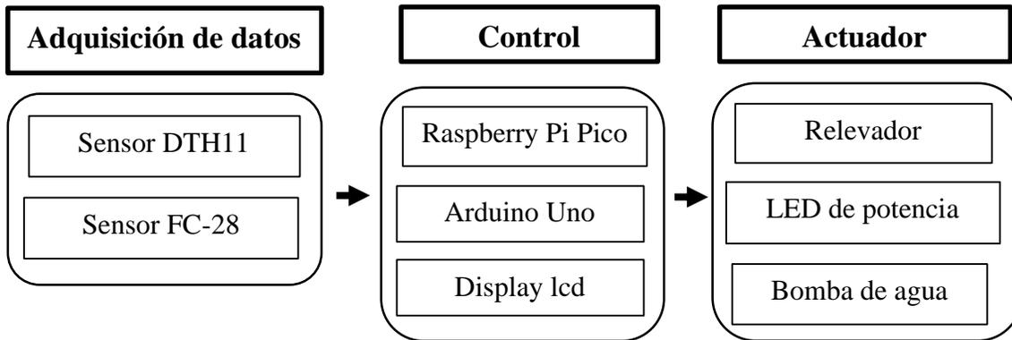
**Figura 1. Diagrama general del sistema artificial no ionizante.**
