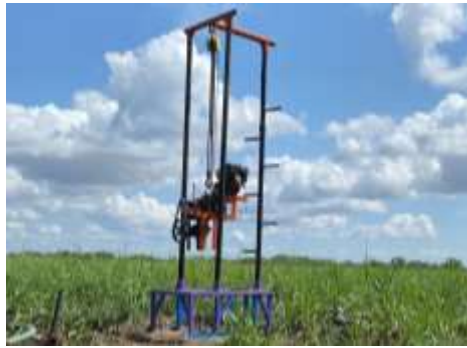
Figura 7.- Equipo de perforación para elaboración de pozos
