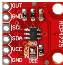
Figura 5. Convertidor digital a analógico de un solo canal, en presentación de montaje de fácil integración. Fuente: Autores.
